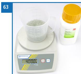
7. Nun befüllen Sie die Messkammer des Gerätes langsam und gleichmäßig mit den 400 g Glasperlen (Bild 64).
