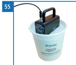
5. Stecken Sie den Sensor des humimeter SG1 zur Gänze in den mit Granulat gefüllten Eimer.
