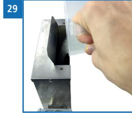
8. Für das Befüllen des Messgerätes darf kein Trichter oder Ähnliches verwendet werden.
