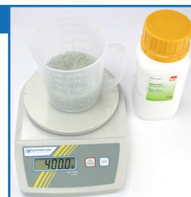
7. Nun befüllen Sie die Messkammer des Gerätes langsam und gleichmäßig mit den 400 g Glasperlen (Bild 43).
