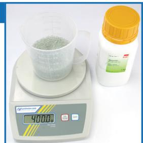
7. Nun befüllen Sie die Messkammer des Gerätes langsam und gleichmäßig mit den 400 g Glasperlen (Bild 29).
