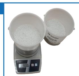
7. Nun befüllen Sie die Messkammer des Gerätes langsam und gleichmäßig mit den 900g Granulat (Bild 17).
