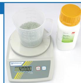
7. Nun befüllen Sie die Messkammer des Gerätes langsam und gleichmäßig mit den 400 g Glasperlen (Bild 36).
