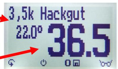
12. Falls der Messwert blinkt, wurde der Messbereich überschritten. In diesem Fall nimmt die Messgenauigkeit ab. Bei Hackgut sollte wenn möglich auf die nächsthöhere Gewichtsstufe umgeschaltet
