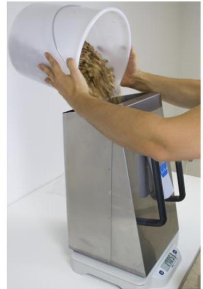
9. Nun muss solange Material entfernt werden, bis die nächst niedrigerer Gewichtsstufe erreicht wird. Fehlt nur wenig (z.B. 0,100 kg) auf die nächst höhere Stufe, so soll auf diese aufgefüllt werden. Das aktuelle Gewicht kann an der Waage abgelesen werden.
